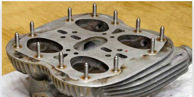
8) Na het vlakken met de solide bevestigde nieuwe tapeinden....
