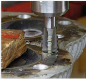
2) handmatig draadtappen in de kolomboor (mooi haaks)
