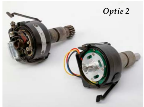
Originele Lucas distributeur & aangepaste Lucas behuizing met 123-uniit naast elkaar
