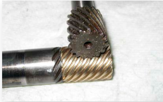
Het frezen van de tanden in het alubrons..... de gereviseerde as met de nieuwe helix er op..
