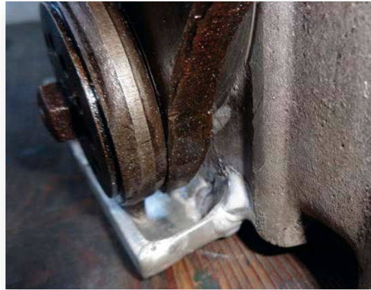
Drijfstang boven 'zijn' dip-bakje.....
