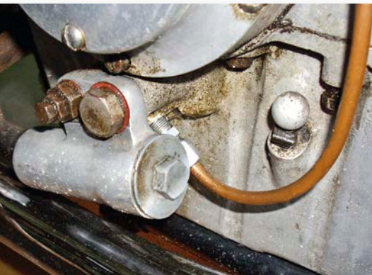
oliefilter aan zijkant rechter buitenzijde blok
