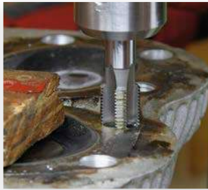
2) handmatig draadtappen in de kolomboor (mooi haaks)
