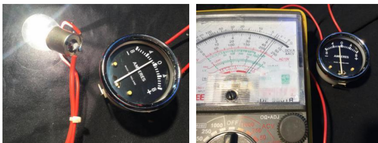
Ampèremeter in serie met lampje / universeelmeter
