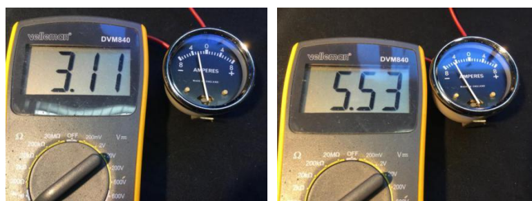
Twee ampèremeters in serie om meting te vergelijken
