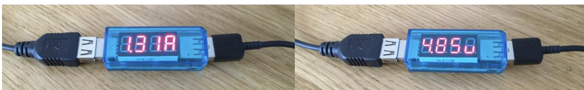
Links: de meter geeft 1,31 A aan / Rechts de meter geeft 4,85 V aan
