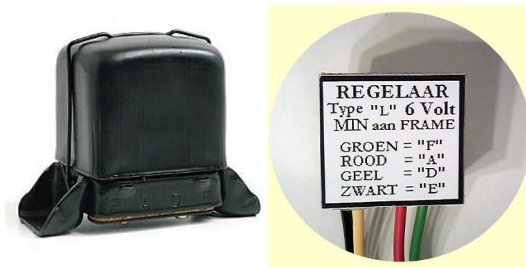
De Beck elektronische regelaar past precies in de Lucas behuizing
